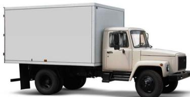
Изотермические фургоны возникли в России немного позже – только тогда, когда спрос на них стал более устойчивым. Основное отличие изотермических фургонов – это утеплитель между внешними слоями обшивки. Именно благодаря нему внутри фургона поддерживается определенная температура. Данная обшивка эффективна также в сочетании с холодильным оборудованием – так она работает, к тому же, в щадящем режиме.
